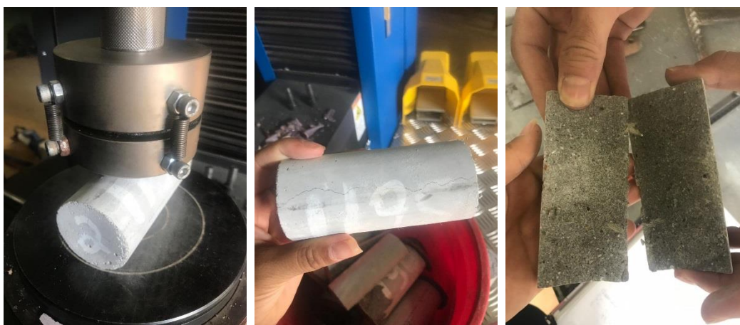
Figura 14 – Ensaio de tração por compressão diametral da argamassa do traço T2
