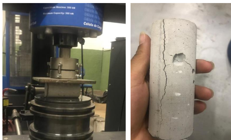
Figura 13 – Ensaio de tração por compressão diametral da argamassa do traço T0
