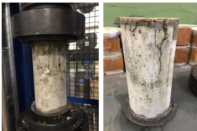
Figura 10 – Ensaio de compressão axial do concreto do traço T0
