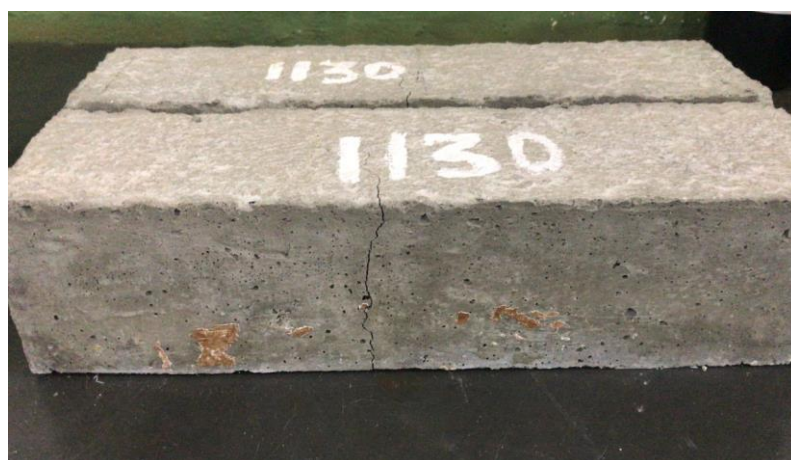
Figura 16 – Ensaio de tração na flexão com 4 pontos do concreto do traço T1
