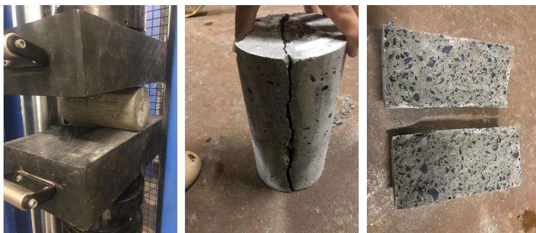
Figura 12 – Ensaio de tração por compressão diametral do concreto do traço T0
