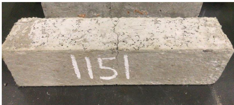
Figura 15 – Ensaio de tração na flexão com 4 pontos do concreto do traço T0,5
